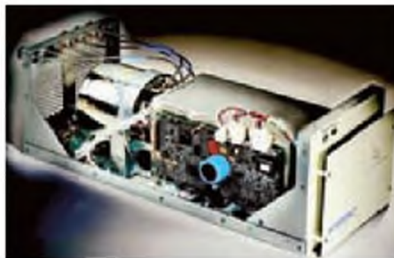
▲ Figura 12.22 Sistema receptor criogénico que emplea un filtro superconductor enfriado por criogenia y un amplificador de bajo ruido (LNA). El objeto cilíndrico de la izquierda es el refrigerador criogénico utilizado para mantener al filtro y al LNA a una temperatura por debajo de su valor T_c .
